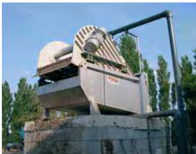
Modèle de tamis vibrant sur son bâti
