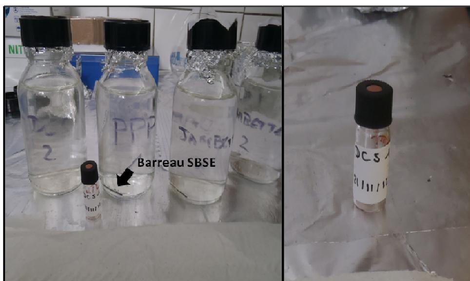
Figure 5 – Photographies illustrant l'arrêt de l'agitation puis la récupération des barreaux en étui.
