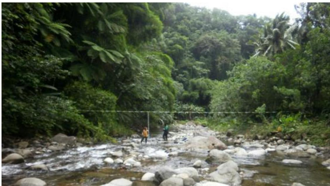
Le décimètre nous permet ensuite de nous repérer pour les mesures inter points. Pour un côté pratique, les mesures « hors d'eau » sont réalisées entre le décimètre et le sol. Le calcul de la valeur négative par rapport à la ligne d'eau est réalisé lors de la saisie des données sur le logiciel. Cette méthodologie, certes « consommatrice de temps » présente l'avantage d'éviter de noter sur la fiche de terrain des erreurs de calcul mental (données par la suite irrécupérables).
