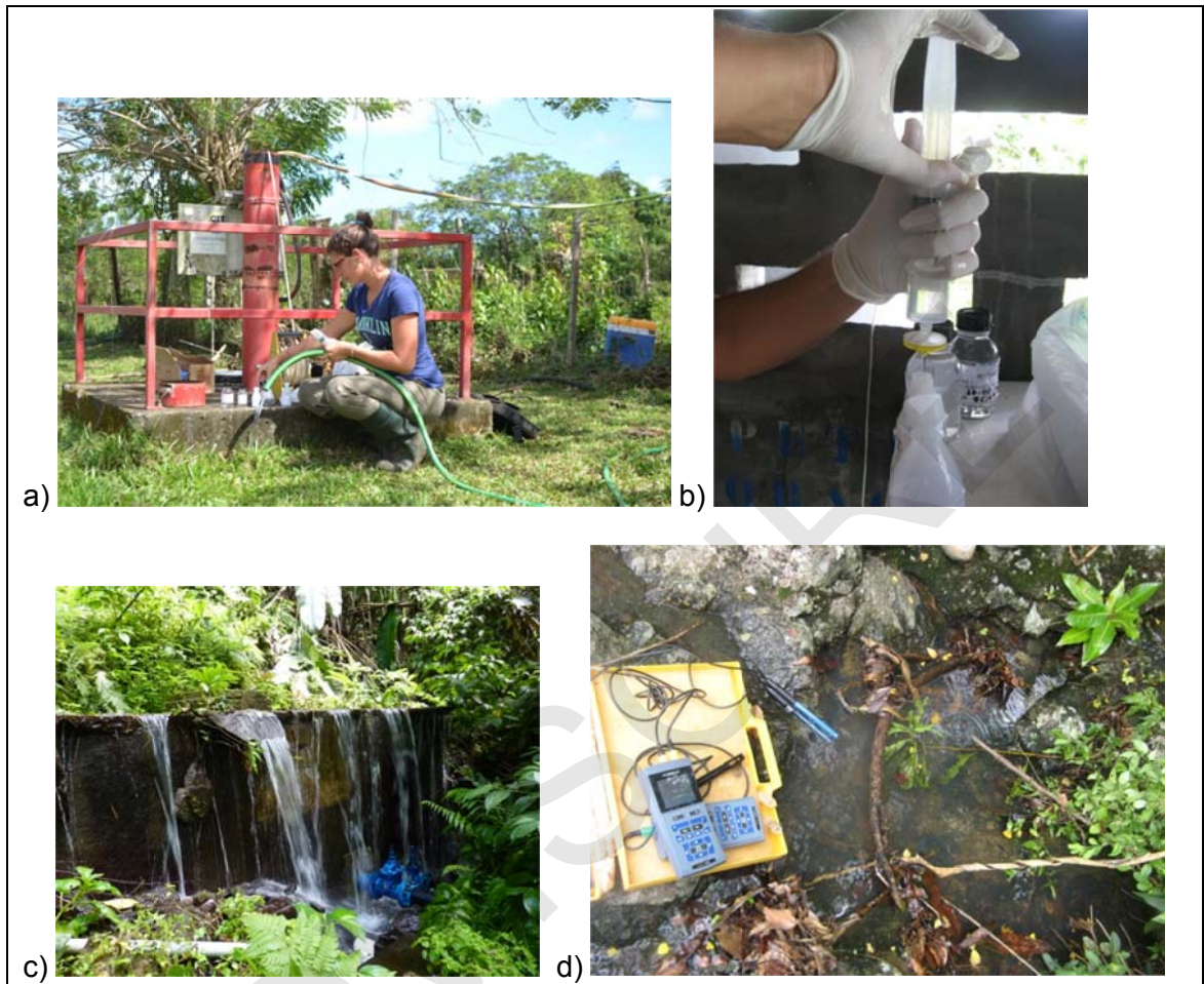
Illustration 3 : Planches photographiques des prélèvements : a) forage Robert – Pontaléry, b) filtration in situ à 0.45 \mu\text{m} , c) source Essente à Morne Rouge, d) mesures des paramètres in situ
