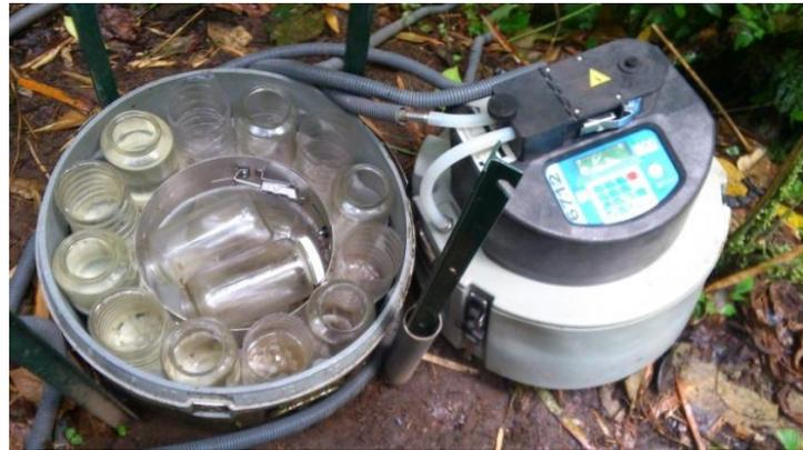
**Photographie 4** : Flacons des échantillons d'eau dans le préleveur, alternance d'une bouteille en verre et d'une bouteille en plastique pour la mesure de toutes les familles de pesticides
