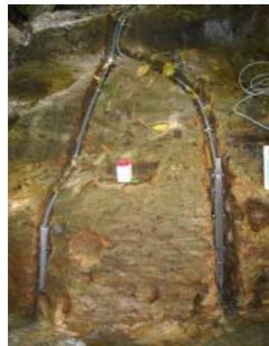
Photographie 2 : Protection de la sonde de pression et crépine
