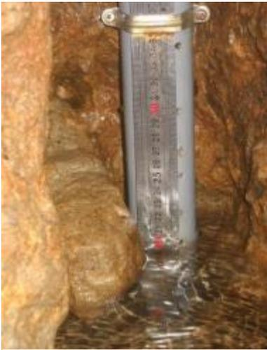
Une échelle limnimétrique est installée dans le lit de la rivière pour calibrer et contrôler les débits calculés par la centrale d'acquisition (**photographie 3**). Ce contrôle visuel permet de vérifier la fiabilité des mesures et des calculs afin de corriger éventuellement les hauteurs d'eau mesurées par rapport aux hauteurs d'eau réelles.
