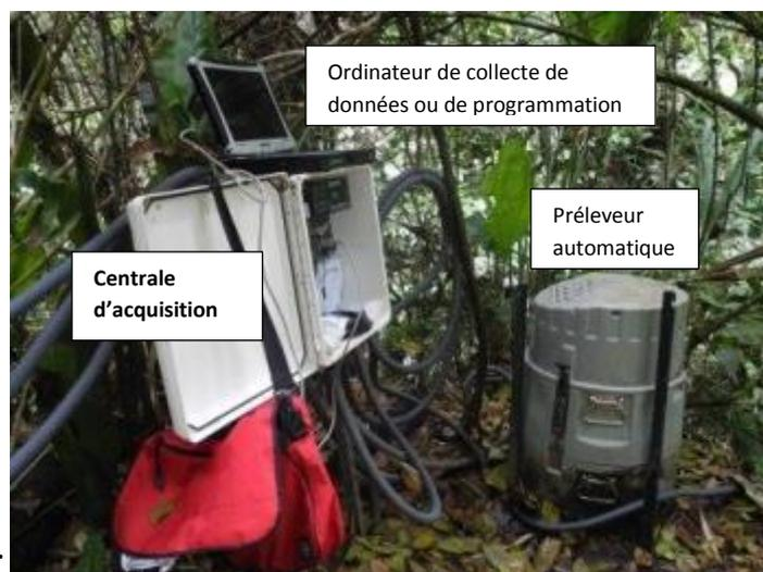
**Photographie 5** : Centrale d'acquisition dans son boîtier de protection couplée au préleveur automatique et connectée à un ordinateur pour récupérer les données enregistrées ou transmettre les programmes de calculs et de prélèvements.
