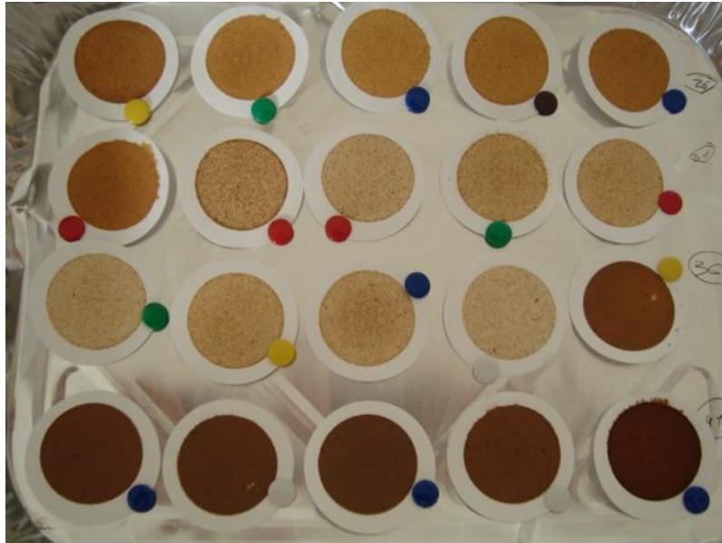
Photo 1 : Filtres utilisés en fibre de verre positionnés dans une barquette en aluminium
