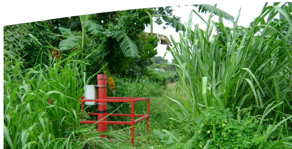
Le piézomètre de Chalvet à Basse Pointe (photo : BRGM)
