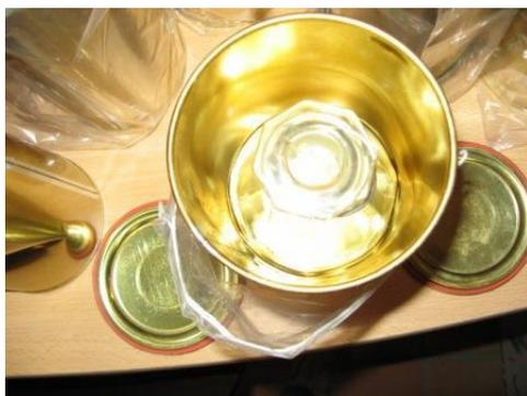
Illustration 43 : Système de prélèvement utilisé pour les CFC et SF<sub>6</sub>
