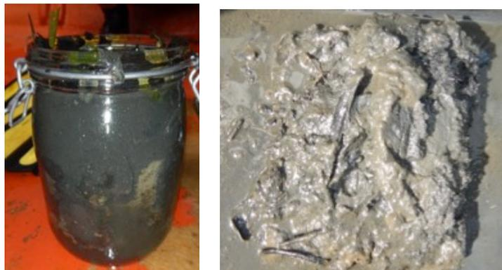
Figure 3 : Exemples de sédiments grossiers problématiques (Impact Mer, 2016). 1. Echantillonnage en plongée avec bocal en verre, 2. Echantillonnage d'un petit volume à la benne.
