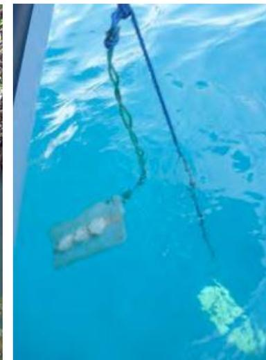
*Echantillonneurs passifs en cours d'installation*
