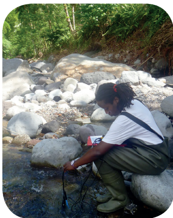
Mesure à la sonde des paramètres in situ, par un agent O.D.E
