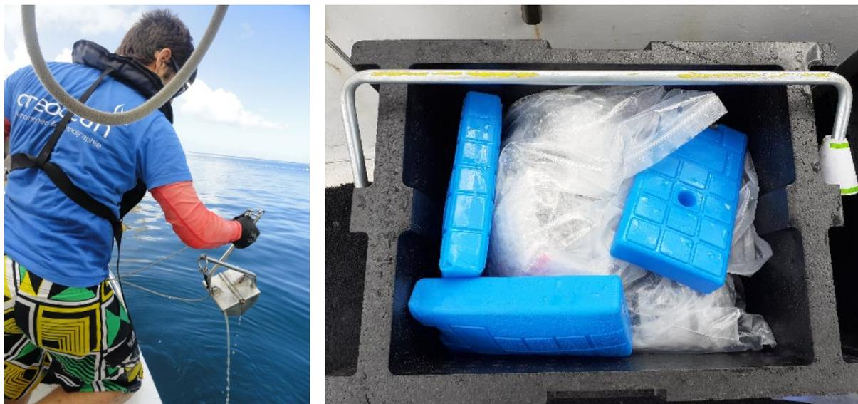
*Figure 5 - Prélèvement à la benne Van Veen et conditionnement des échantillons*
