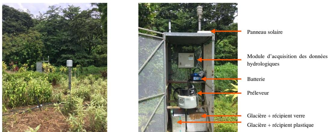
Figure 8 : Equipement d'une station de prélèvement.
